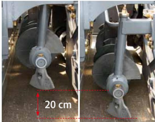
Die **Materialquerförderung** vor der Bohle bietet beim SUPER 1800-2 alle Möglichkeiten um eine optimale Mischgutvorlage in jeder Einbausituation zu erzielen. Leistungsstarke hydrostatische Einzelantriebe von Kratzerband und Verteilerschnecke ermöglichen hohe Einbauleistungen von bis zu 700 Tonnen pro Stunde.
