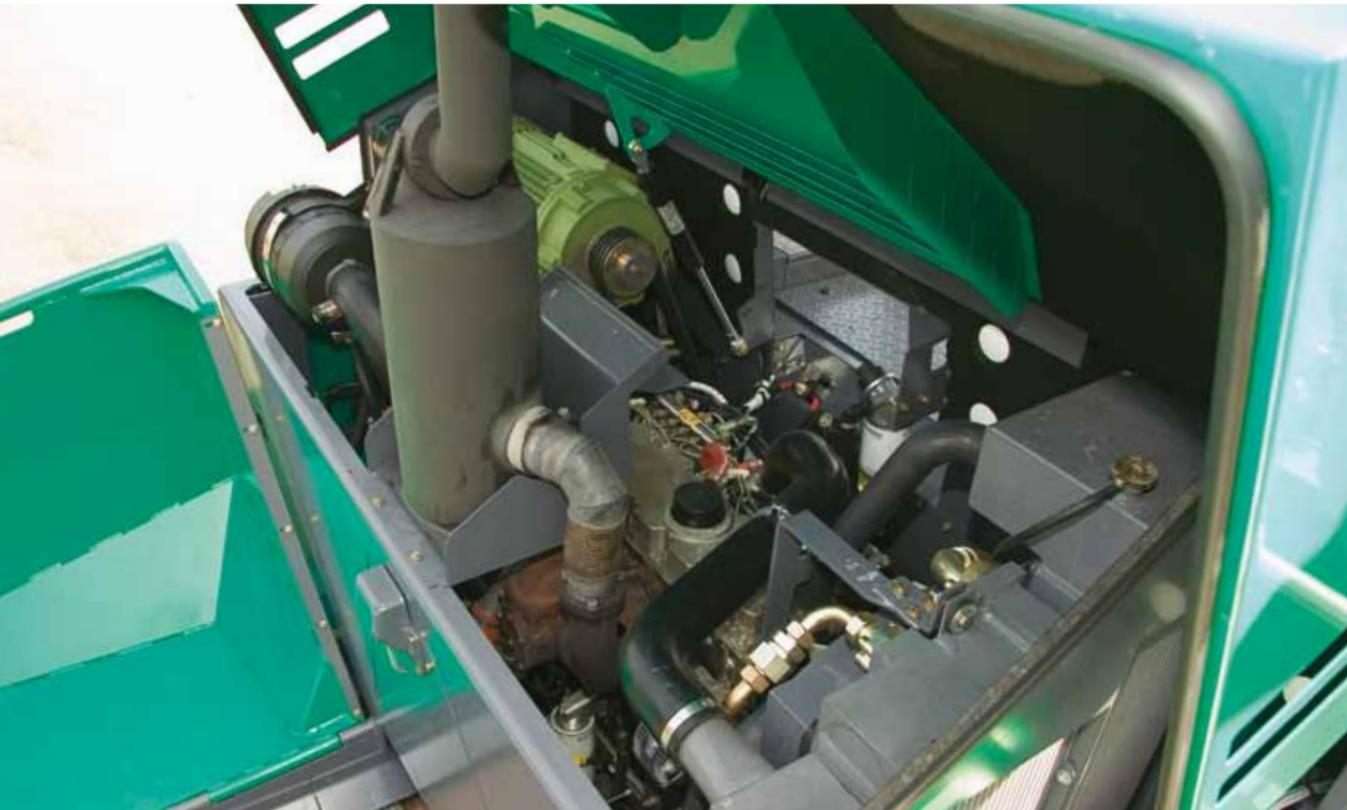
Ein moderner, flüssigkeitsgekühlter PERKINS Motor mit 129,6 kW treibt den SUPER 1800-2 an. Mit den Drehzahlstufen MIN, ECO und MAX lässt sich die Motorleistung fein abstimmen. Für 70 – 80 % aller Arbeiten ist die ECO-Stufe ausreichend, wodurch sich Kraftstoffverbrauch, Verschleiß und Geräuschemission reduzieren lassen.
