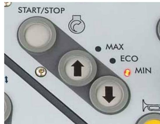
Verschiedene Drehzahlstufen sind einfach per Knopfdruck wählbar (MIN, ECO, MAX).
