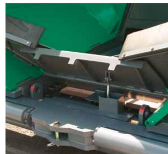
Wie alle VÖGELE Fertiger kann auch der SUPER 1800-2 extrem sauber, sicher und zügig beschickt werden. Die hydraulische Behälterfrontklappe (Option) sorgt dafür, dass die komplette Mischgutmenge in den Materialförderungsprozess eingebunden wird.
