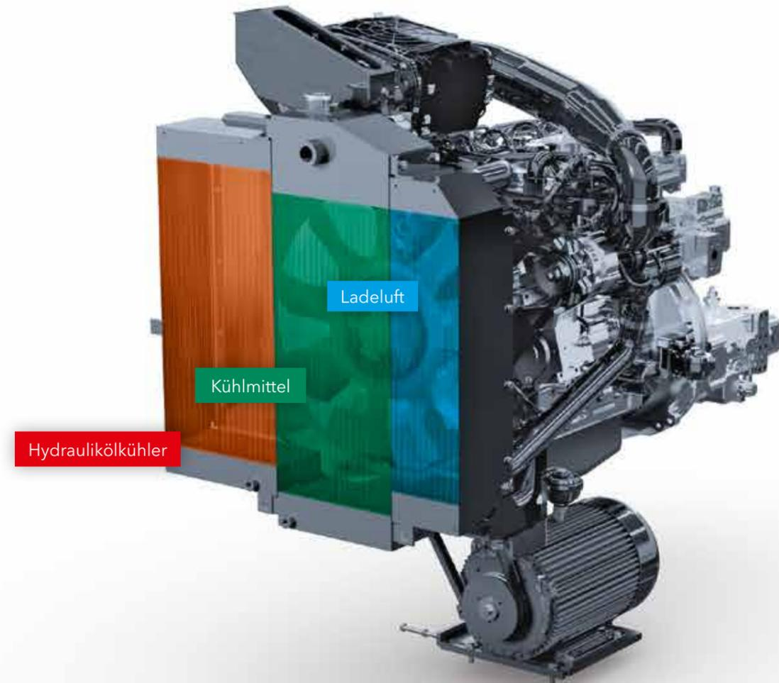
Der groß dimensionierte Mehrfeldkühler ist in drei Bereiche unterteilt. Durch ihn werden die Ladeluft, die Kühlflüssigkeit des Motors und das Hydrauliköl auf optimale Temperatur gehalten.
