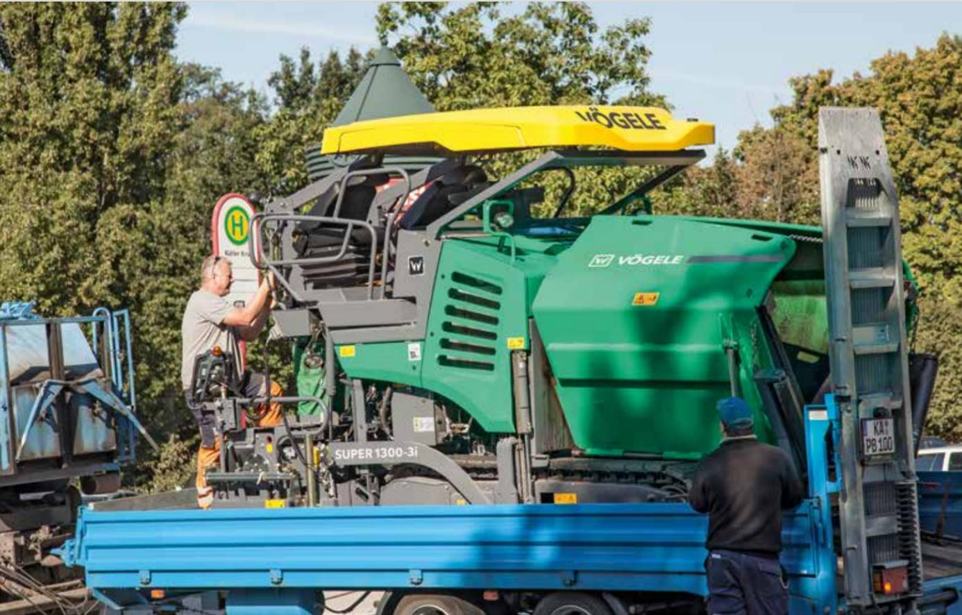
**Kein Bauteil** ragt beim SUPER 1300-3i aus der schlanken Silhouette hinaus. Mit hochgeklappten Behälterwänden beträgt seine Grundbreite schmale 1,85 m bei einer Länge von nur 4,95 m. So kommt er fast überall hin und überall durch. Trotzdem kann er bis zu 5,00 m breit einbauen. Dies ist in dieser Klasse bisher unerreicht.
