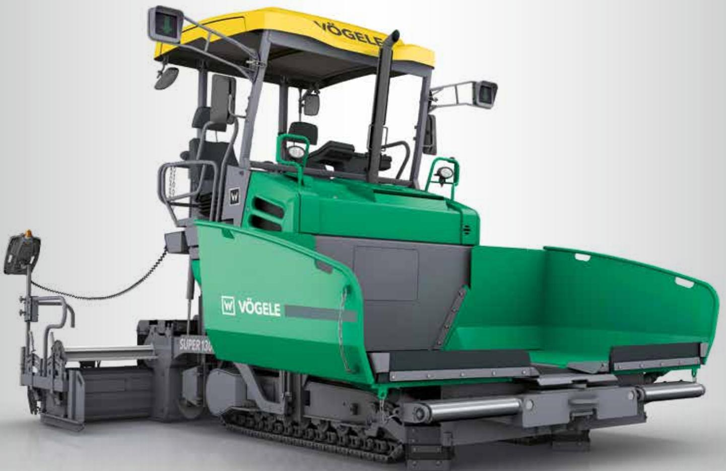
Maximale Einbaubreite 5,00 m
