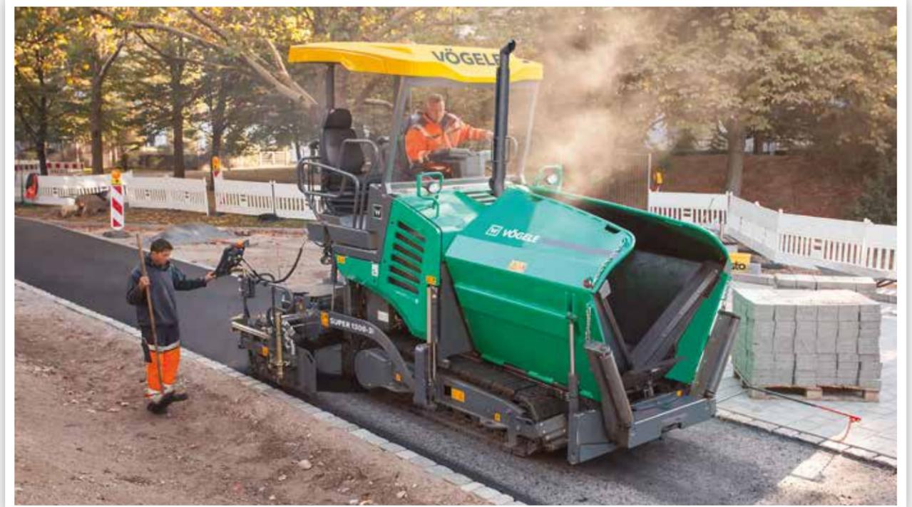
**Der SUPER 1300-3i** ist ein extrem kompakter Straßenfertiger, der sich durch seine geringen Abmessungen für eine große Bandbreite unterschiedlicher Anwendungen eignet.
